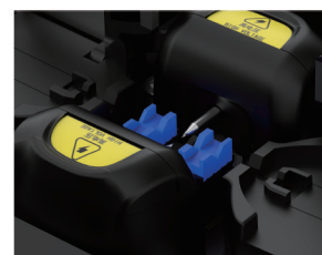
SUPPORTO IN CERAMICA (V) AD ALTA PRECISIONE
